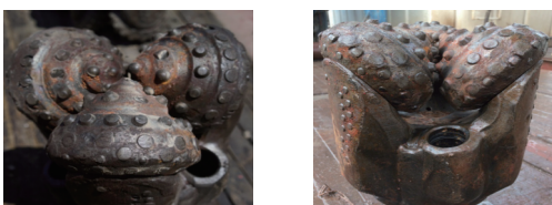
图8 三牙轮钻头缩径与牙齿磨损
