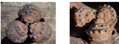
图9 外排齿脱落或严重磨损导致的钻头缩径
